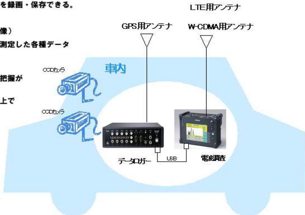
【データ収集のシーンで...】 走行中の映像とGPS、エリアテスターで測定した各種データを同期収録します。
